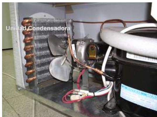
La limpieza del condensador debe realizarse con un cepillo plástico, soplando con aire comprimido o gas carbónico.
