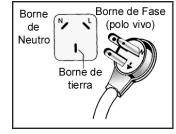
Bajo ninguna circunstancia se debe cortar el cable colocando ficha de dos bornes o usar adaptadores para su conexión a la red eléctrica.
